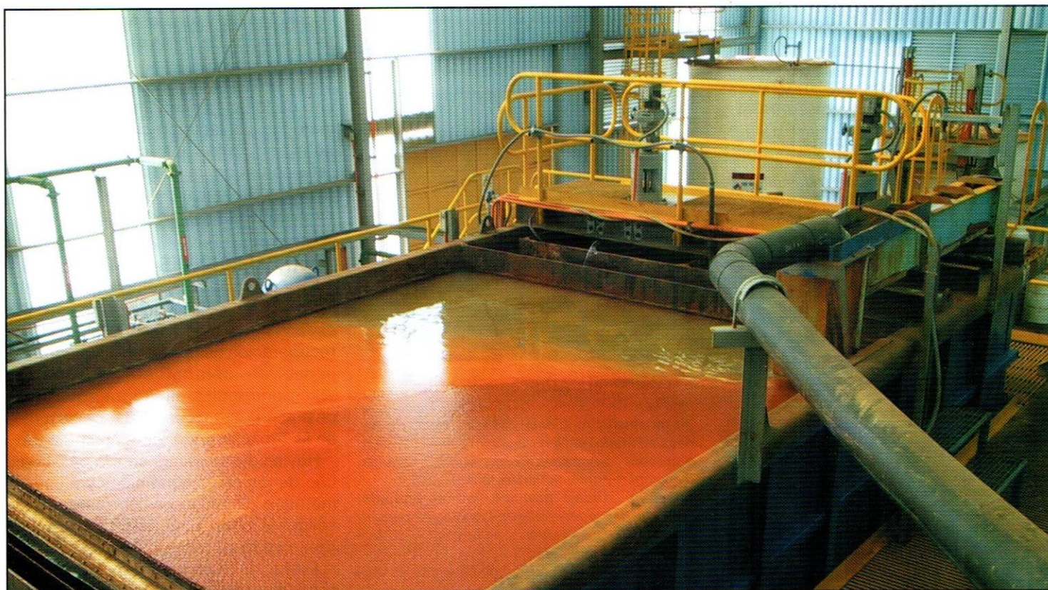
Celda de Flotación por Aire Disuelto (30 L/s) diseñada por Idetec S.A. Planta Tratamiento de Efluentes Punta Chungo, Minera Los Pelambres.
